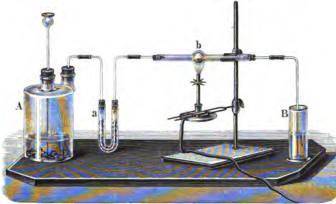
Schwefelwasserstoff aus Schwefelantimon mit Wasserstoff.
